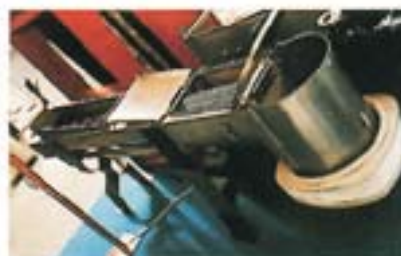
Compactador abierto con cabezal ensacador.
